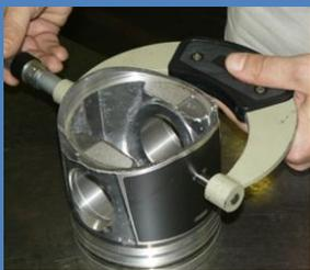
В соответствии с техническими условиями на ремонт двигателя любой марки измерения гильз и поршней необходимо производить строго измерительным инструментом
