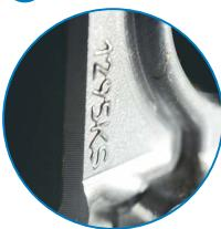
Поршни 44 серии изготовлены из нового высокопрочного сплава 1295KS, запатентованного немецким моторостроительным концерном Kolbenschmidt. Данный вид сплава обладает большой прочностью, способностью работать в очень широком температурном диапазоне, имеет низкий коэффициент температурного расширения. Эти преимущества делают поршень устойчивым к перегрузкам и даже к кратковременным перегревам.
