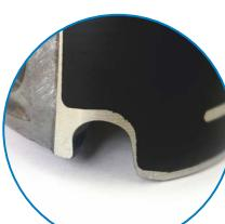
Поршень 740.1004015-10K-44, в новом 44ом исполнении изготавливается из одного сплава с поршнем 740.30-1004015-44. В связи с этим для изготовления данных поршней применяется одна и та же отливка. Как следствие на поршне 740.1004015-10K-44 появилась «выборка» под форсунку.
