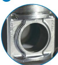
Проанализировав практический опыт применения поршней новой конструкции в двигателях со значительным пробегом, инженеры компании приняли решение не просто оставить в конструкции поршней 44 серии «холодильник», но и увеличить его форму. Это позволило уменьшить площадь трения поршня о гильзу, а также полностью исключить возможность появления задиров в зоне бобышек поршня в момент повышенных температурных нагрузок, в том числе в случае нарушений работы поршневого пальца.
