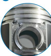
В поршне «Мотордеталь» сохранены маслоотводящие каналы оптимальной формы и глубины, что положительно сказывается на работе маслосъёмных колец и значительно снижает риск возникновения повышенного расхода масла. Отсутствие данных каналов влечет необходимость удаления излишков масла через зазор между поршнем и гильзой, который в различных температурных условиях нестабилен. Это приводит к «всплытию» маслосъемного кольца и ухудшению его свойств, влекущих за собой увеличение расхода масла.
